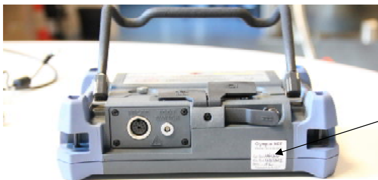
Рисунок 2 – Схема пломбировки от несанкционированного доступа
