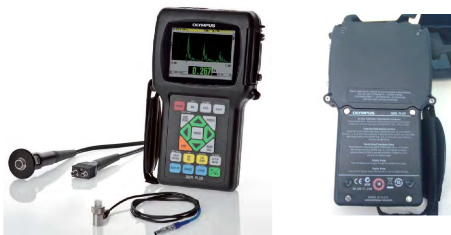
Рисунок 1 – Внешний вид толщиномеров 38DL PLUS
